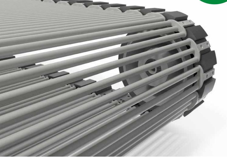
Il prodotto può rimanere incastrato tra due barre mentre il nastro gira intorno alla puleggia di ritorno. A parte questo, la cinghia di trazione di un nastro a barre doppie si consuma più rapidamente a causa della rigidità della rivettatura ad un passo minore. Le aste triple garantiscono una maggiore durata delle cinghie e una luce libera fra le barre assolutamente costante.
