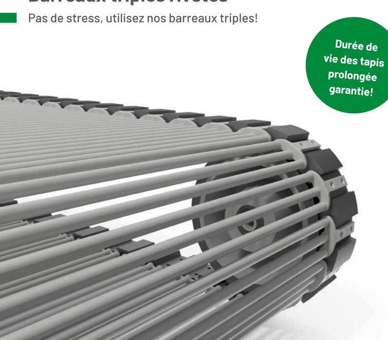
Le produit peut rester coincé entre deux barreaux doubles lorsque le tapis tourne autour des galets. En outre, les bandes de traction d'un tapis à barreaux doubles s'usent rapidement en raison du caractère rigide du rivetage. Les barreaux triples garantissent une durée de vie des tapis plus longue et un vide constant entre les barreaux.
