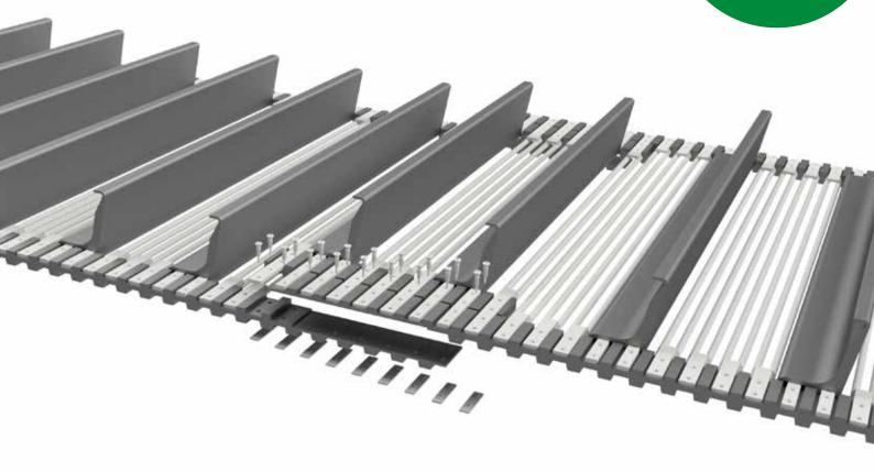
En todas las bandas transportadoras, la unión es la parte más débil, pero no siempre es posible utilizar un cierre sin fin. En muchas aplicaciones, las bandas tienen que ser sustituidas porque la unión falla. La Helperbelt (correa auxiliar patentada de Broekema) recupera toda la resistencia a la rotura de las correas en la zona de unión.
