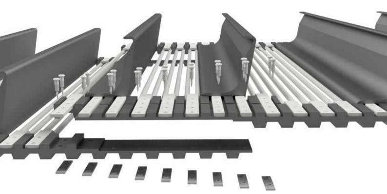
La Helperbelt es una innovadora solución patentada por Broekema, que permite al usuario montar una banda de varillas no acabada en sin fin, sin comprometer su resistencia a la rotura.
