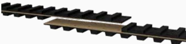
Bei einer überlappten Verbindung sind beide Gurtenden gerade abgestuft, so dass die beiden Gurthälften bei der Montage des Gurtes perfekt zusammenpassen. Bei der Montage des Gurtes schraubt der Benutzer die Stäbe des Überlappungsstoßes an der Verbindung selbst fest. Diese Verbindung ist stabiler als eine mechanische Verbindung, erfordert aber mehr Zeit für den Einbau/Austausch. Stege mit einer Überlappungsverbindung können durch Abschrauben der Überlappungsstäbe geöffnet werden.
